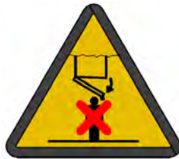
66945 - "Swivel range" warning sign
